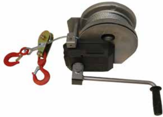
Handseilwinde AL-KO, Typ 1201 A mit Seil und Umlenkrolle mit Abrollautomatik, Kurbel abnehmbar, inkl. 6 mm Stahlseil, Lochbild: 100 x 55 mm
