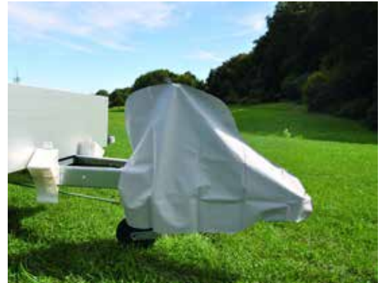
Wetterschutz Deichsel - inkl. Gummispanner für festen Halt
