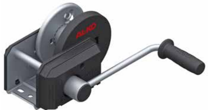
Handseilwinde AL-KO, Typ 501 PLUSA ohne Seil Kurbel fest montiert, Trommelkapazität bei 5 mm Seil: 20 mtr., Lochbild 100 x 50 mm
