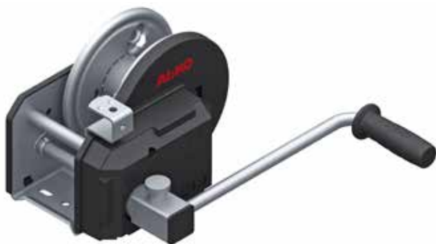
Handseilwinde AL-KO, Typ 901 PLUSA ohne Seil mit Lastdruckbremse, Kurbel abnehmbar, Trommelkapazität bei 7mm Seil: 20 mtr., Lochbild 100 x 55 mm
