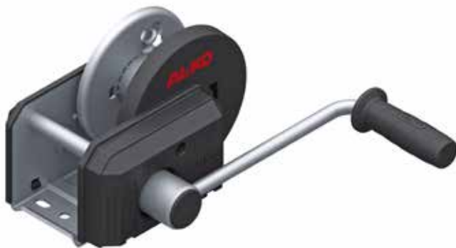
Handseilwinde AL-KO, Typ 301 PLUSA ohne Seil Kurbel fest montiert, Trommelkapazität bei 4 mm Seil: 15 mtr., Lochbild 58 x 40 mm
