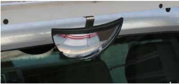
Panoramaspiegel für Leuchenträger für Blitzlader und Speeder, Voraussetzung Leuchenträger
